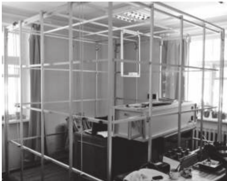
Екранована від зовнішнього геомагнітного поля кімната MMLFC, у якій міститься магнітометрична апаратура (на передньому плані — установка для термомозмагнічування — піч MMTD (Великобританія)
