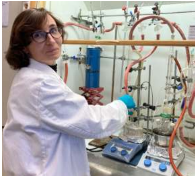
Оксана Дударко за роботою в Інституті молекулярних наук SLU. Вакуумна сушка зразка сорбента
